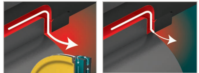
Die variable Öffnung öffnet und schließt sich, um den Druck in der Ausgleichskammer dynamisch zu steuern.
