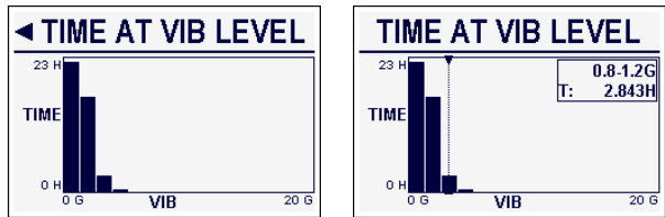
图 7.18：时间与振动水平的关系。右图显示了高亮显示的振动和时间细节。
