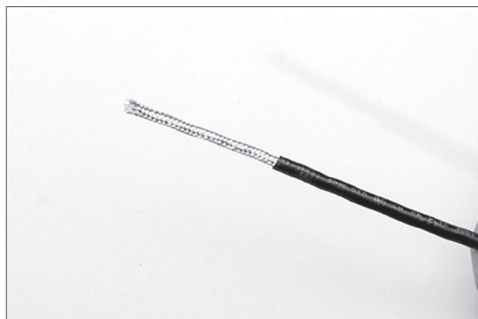
图 3.7: 拆卸外部塑料护套
