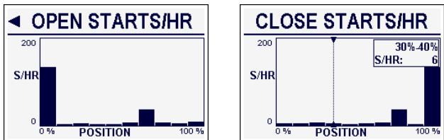
图 7.10：开启和关闭启动次数/小时直方图关闭启动次数/小时直方图显示可选条柱的启动次数/小时和位置值。
