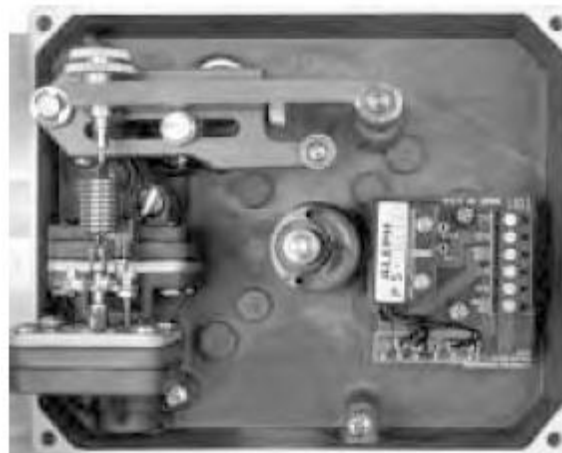
Abb. 6: XL90 Option Näherungsschalter (für bessere Sicht wurde der Nocken entfernt)
